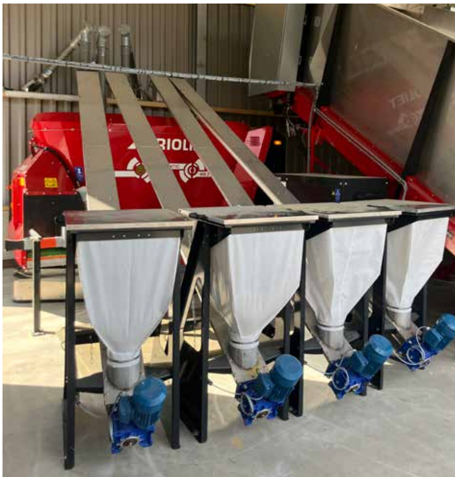
Doseur de minéraux avec sac de stockage de 120 litres et vis auge en acier inoxydable
