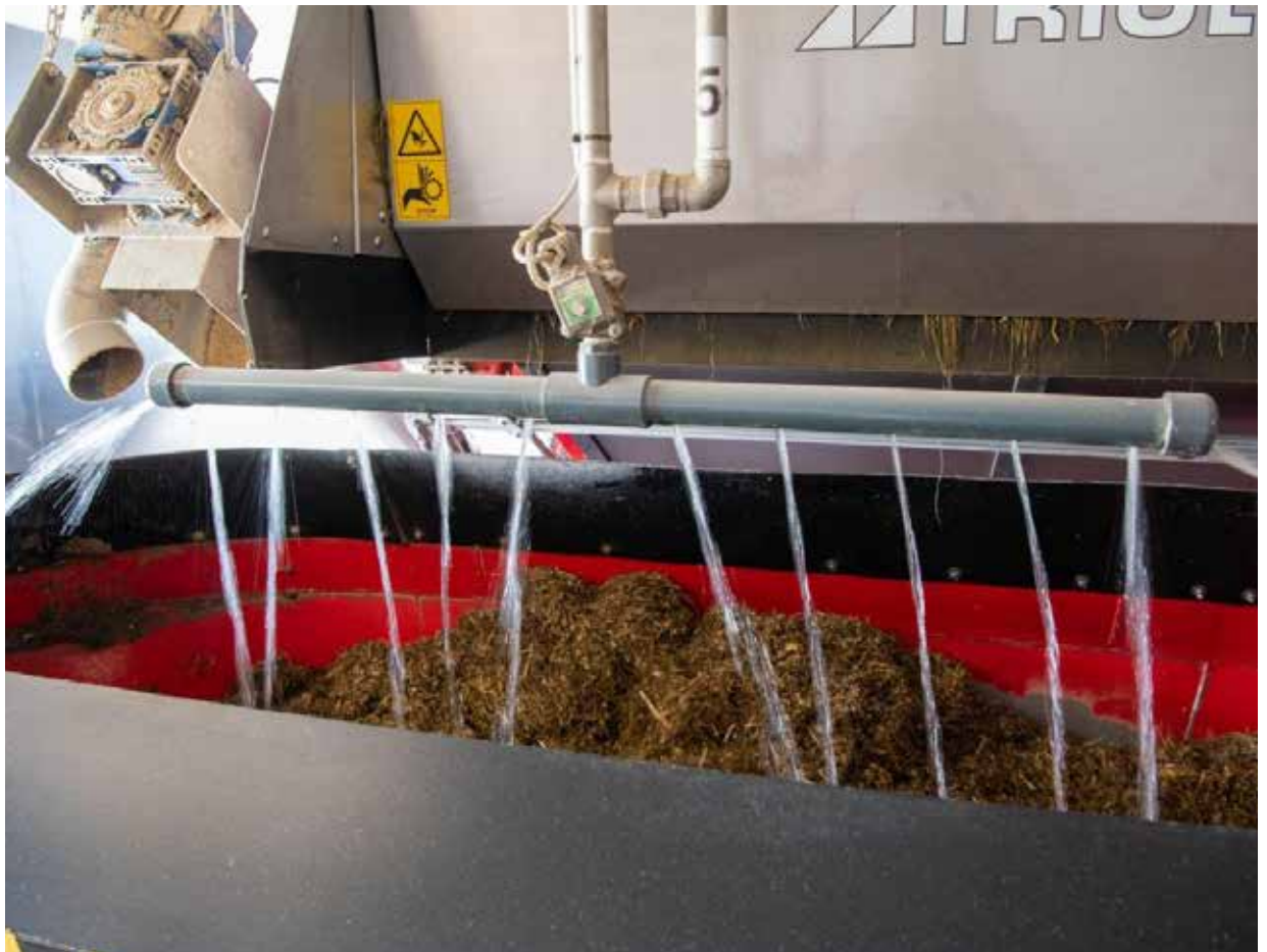
Système d'alimentation en eau complet avec rampe de pulvérisation de 1 m
