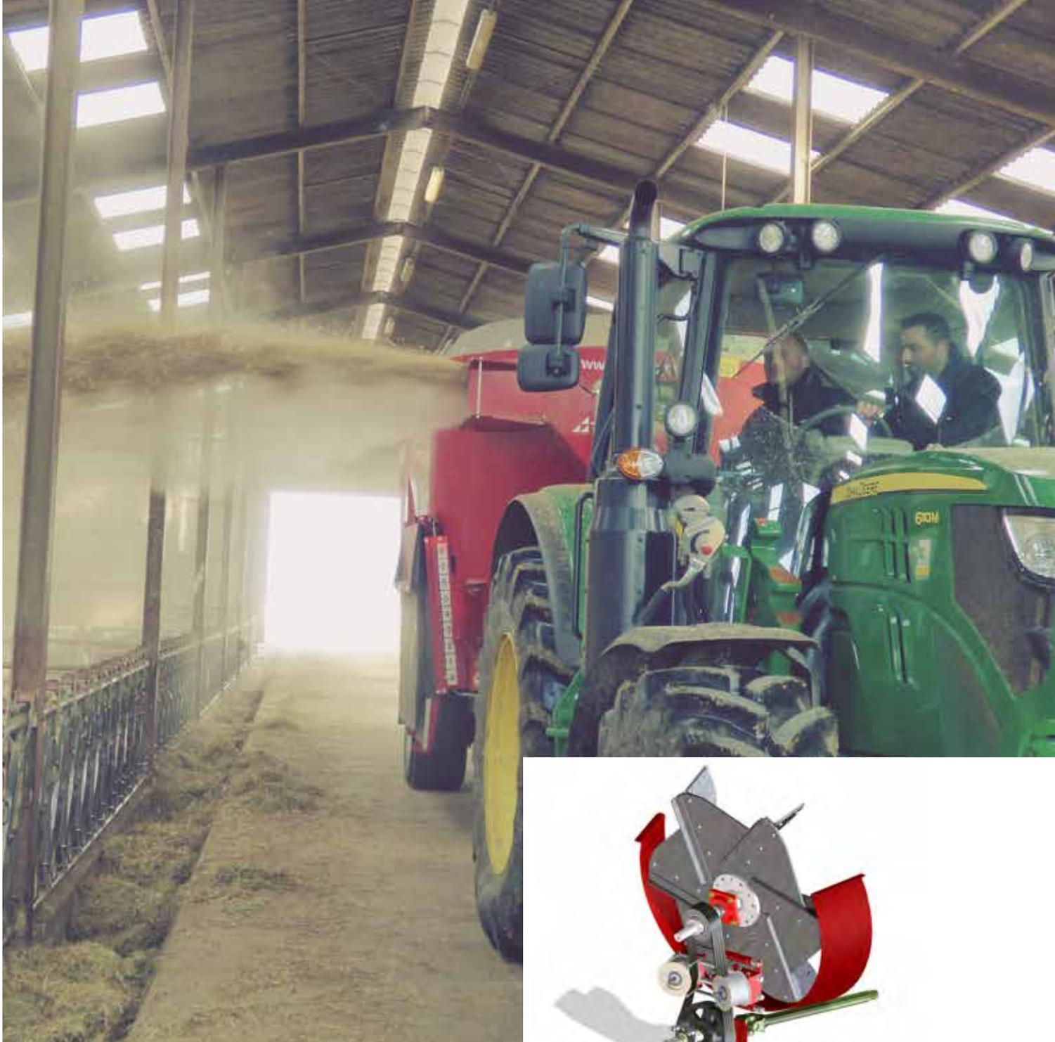
La pailleuse est équipée de lamelles amovibles, ce qui facilite l'entretien. L'orifice d'évacuation du goulotte de soufflage peut être dirigé horizontalement et verticalement de manière à permettre d'épandre de la paille à n'importe quel endroit du bâtiment.
