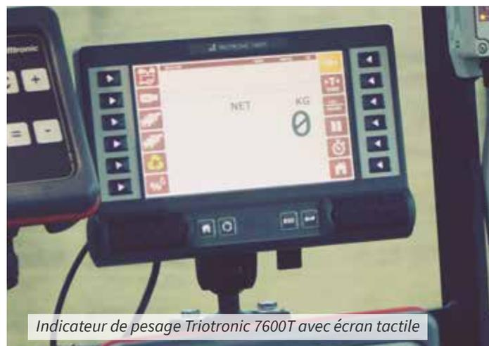
Indicateur de pesage Triotronic 7600T avec écran tactile
